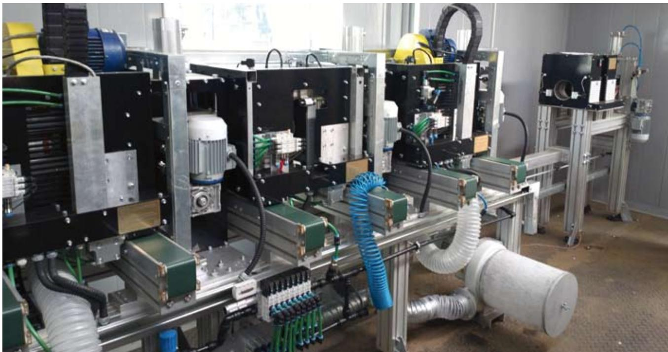
Установка «БУРАН 5000» для дефектоскопии труб – мобильный вариант исполнения
