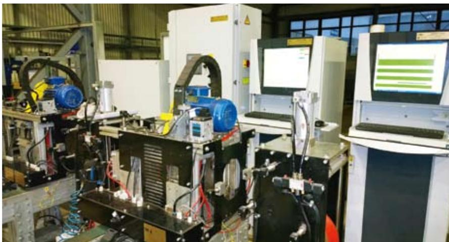
Установка «БУРАН 5000» для дефектоскопии труб – стационарный вариант исполнения
